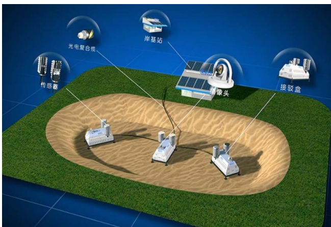
图1 我国首个水下观测网水质在线监测系统
